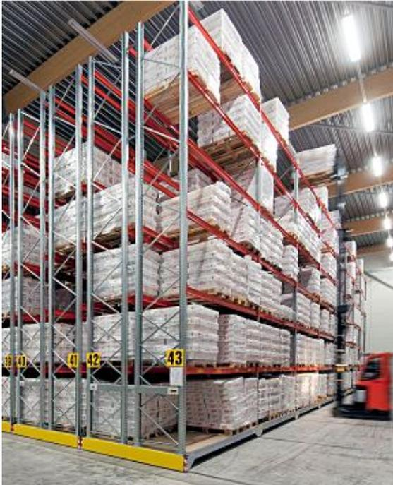
**Verschieberegalen können die Lagerkapazität in Ihrem Lebensmittel- oder Getränkelager um ein Vielfaches steigern. P90-Palettenregale werden auf Verfahrwagen, die sich auf ein im Boden eingelassenes Schienensystem bewegen, montiert. Das durchdachte Steuerungs-Konzept mit modernster Sensortechnik bietet vielfältige Möglichkeiten für eine komfortable Bedienung. Die Regale werden verschoben und bilden so einen freien Gang für die Kommissionierung. Nicht benötigte Gänge werden geschlossen.**
