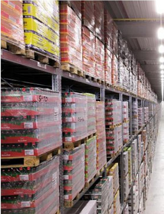
**Selbst in modernsten Lebensmittel- und Getränkelagern sind Standard-Palettenregale die häufigste Form der Palettenlagerung. Dank der vielfältigen Aufstellmöglichkeiten dieses Systems – wie die einfache oder doppelte Tiefenkonfiguration – können Sie dieses Lagersystem individuell an Ihre speziellen Bedürfnisse anpassen.**
