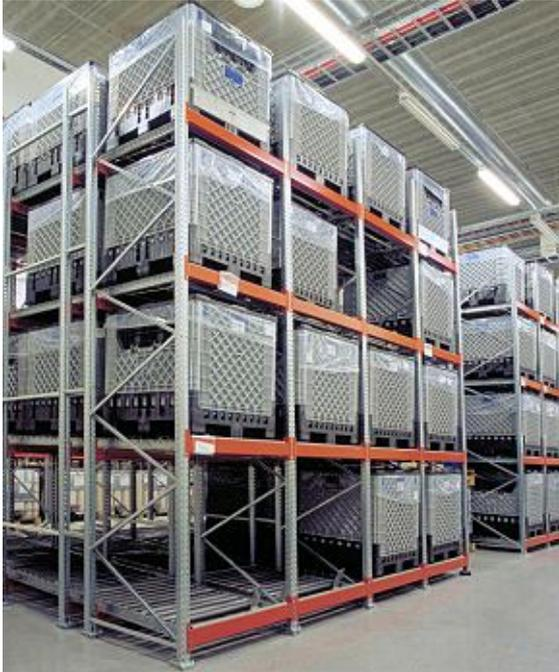
**Durchlaufregale für Paletten oder Kartons eignen sich hervorragend für FIFO- Kommissionierung. Bei Waren mit hoher Durchlaufrate – die in der Lebensmittel- und Getränkeindustrie häufig anzutreffen sind – gewährleisten Durchlaufregale die richtige Reihenfolge des Produktversands.**
